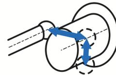
3 Punkte an der Welle oder Bohrung antasten
